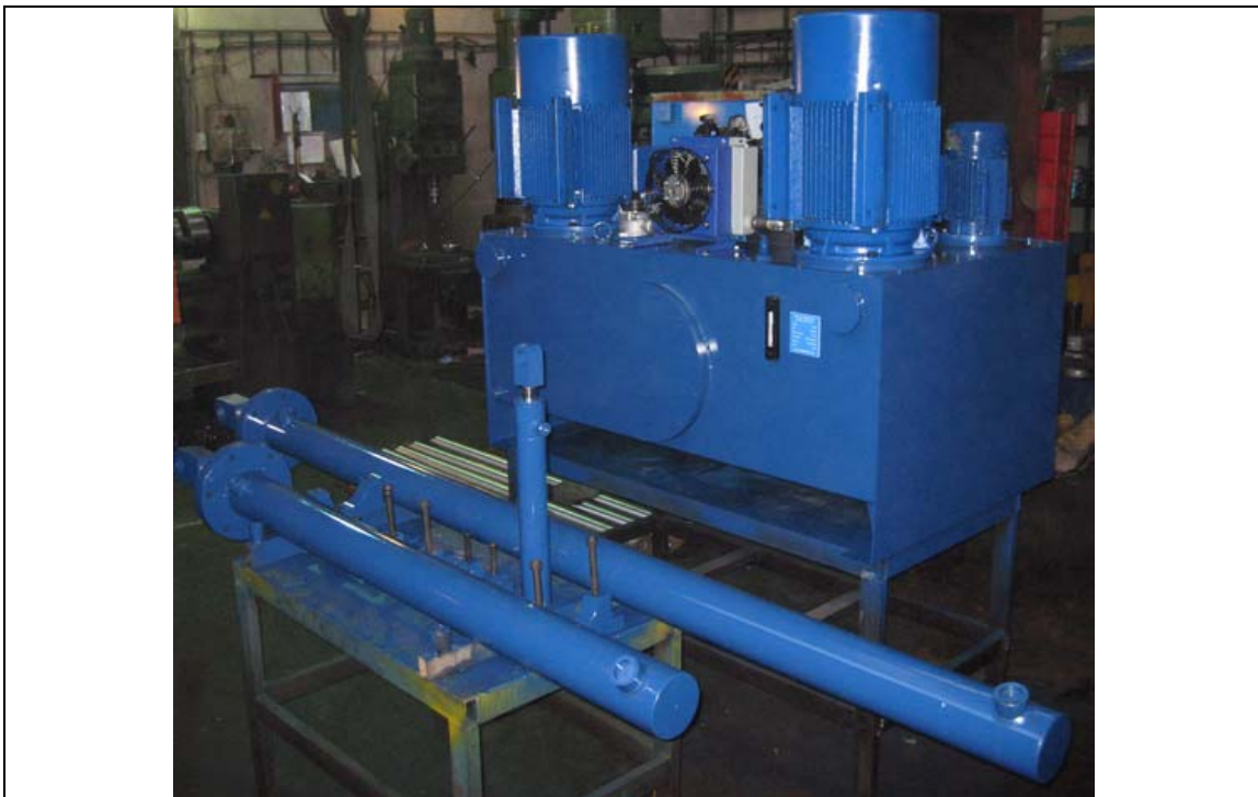
یونیت و سیلندره‌های هیدرولیک سرعت بالا مربوط به کمپکت علوفه - شرکت بنیان تدبیر پارس
