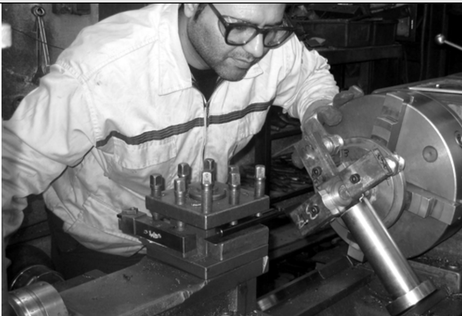
تراشکاری یکپارچه بدنه سیلندر استیل
