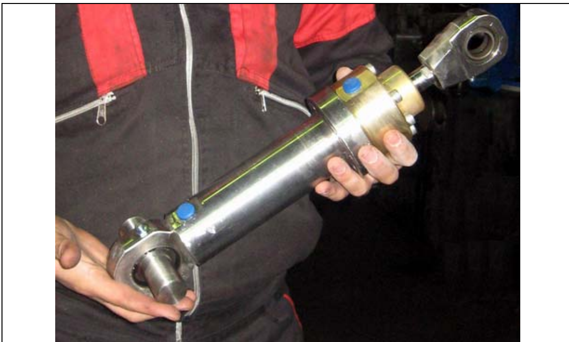
کنترل نهائی سایز سیلندر و انجام تست فشار و نشتی - WP=100bar
