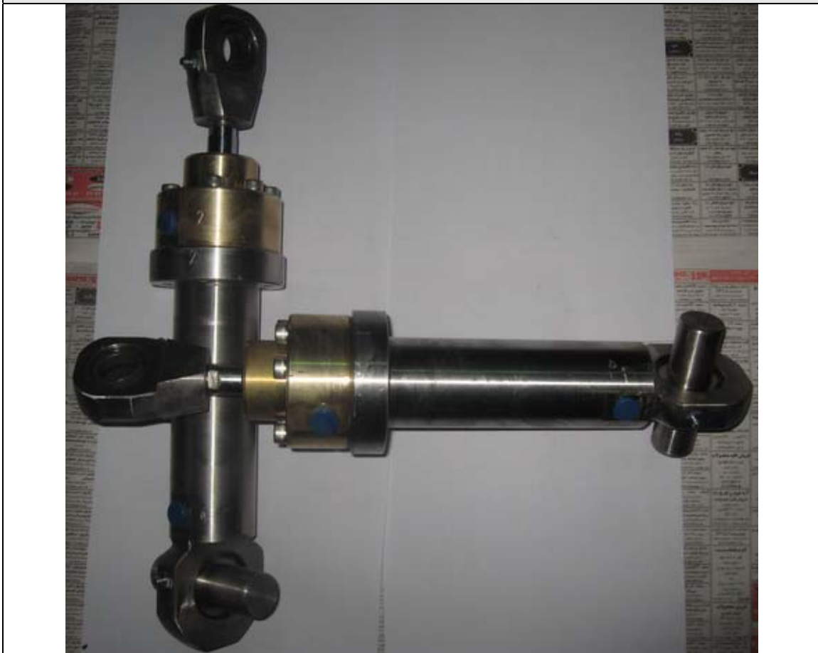
مونتاژ نهائی سیلندرهای استیل با قطر پیستون D=40\text{mm}
