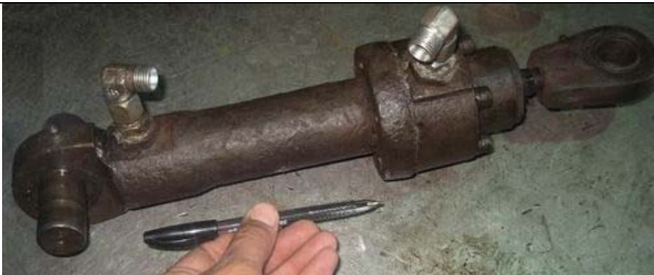
نمونه سیلندر موجود مشتری پس از کار در محیط مرطوب و خورنده
