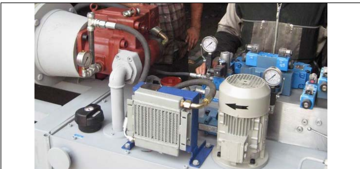
روغن خروجی پمپ دبی متغییر توسط خنک کن مستقل خنک میشود
