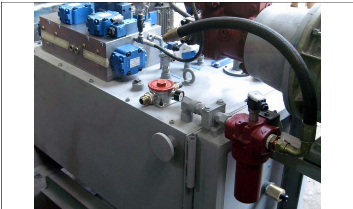
یونیت مجهز به صافی مکش 90 میکرون ، فیلتر خط فشار 10 میکرون ، فیلتر خط برگشت 25 میکرون و فیلتر هوای 2 میکرون است
