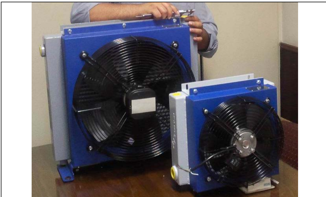
برای خنک کاری سیستم هیدرولیک با توجه به کارکرد ۲۴ ساعته دستگاه از دو خنک کن موازی استفاده شده است
