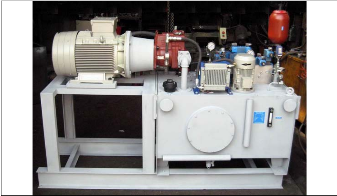
نحوه قرار گیری مخزن و الکتروموتور با توجه به فضای موجود برای نصب میباشد
