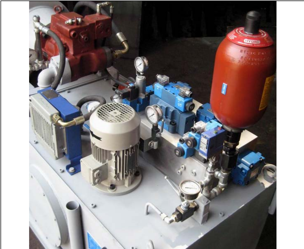
روغن لازم جهت تحریک خط پیلوت قفلهای سیستم توسط آکومولاتور تامین میگردد
