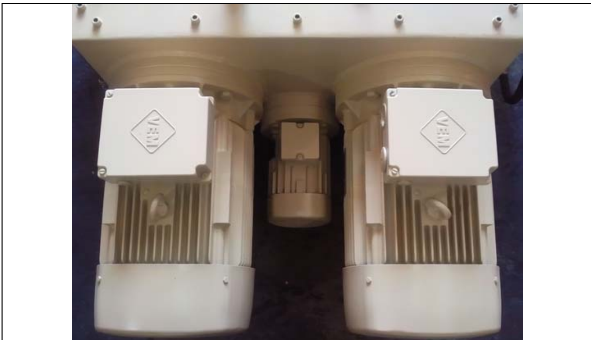
استفاده از الکتروموتورهای سه فاز با توانهای مختلف در یک سیستم موبایل هیدرولیک (تامین برق توسط دیزل ژنراتور)
