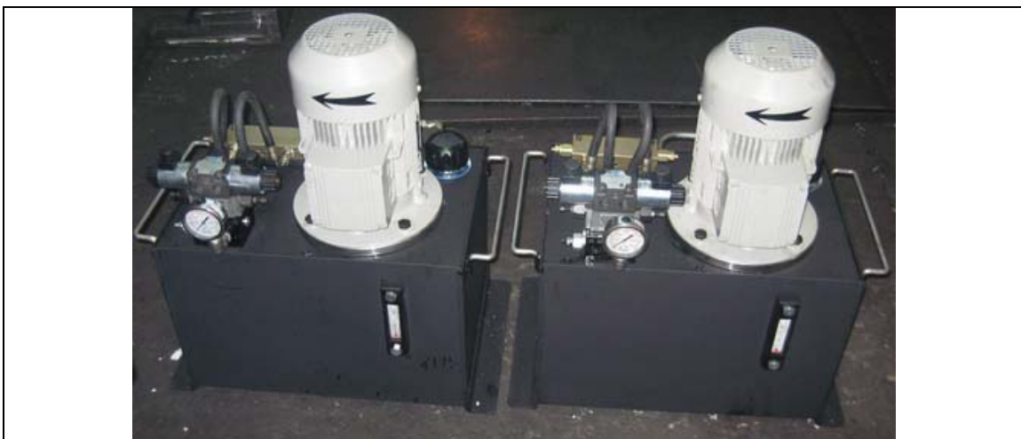
یونیت‌های هیدرولیک شامل موتورهای سه فاز به سفارش گروه هفت
