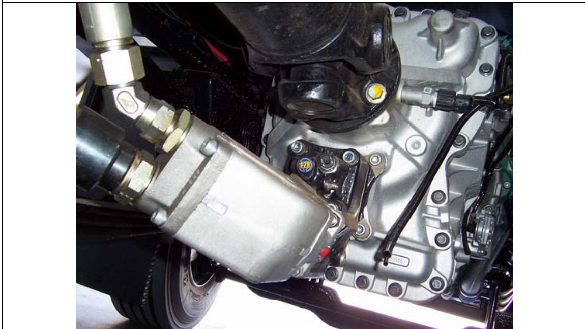
محرک پمپ هیدرولیک در سیستمهای موبایل ( PTO )
