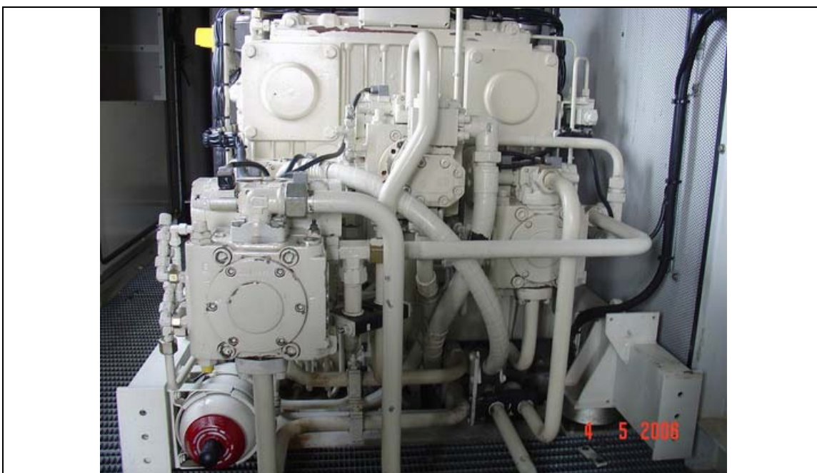
استفاده از موتور دیزل و گیربکس مخصوص در جرثقیل های بندری
