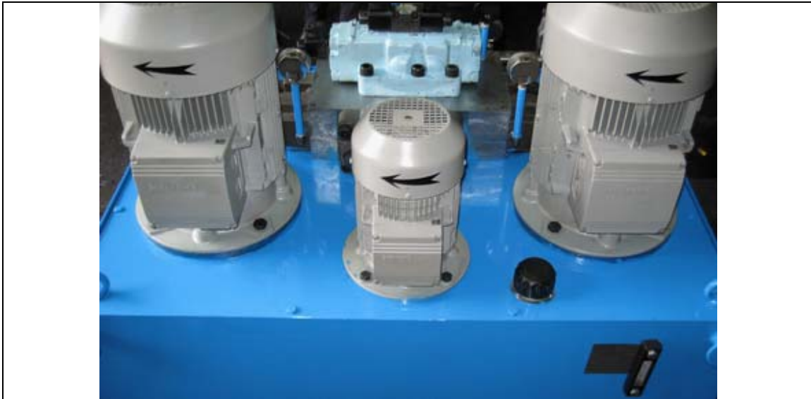
یونیت هیدرولیک شامل چند پمپ برای ایجاد سرعت متغیر به سفارش شرکت ندا پرداز
