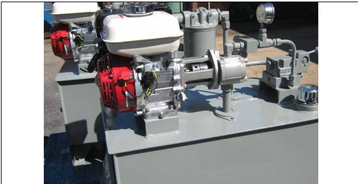
استفاده از موتور بنزینی به عنوان محرک پمپ
