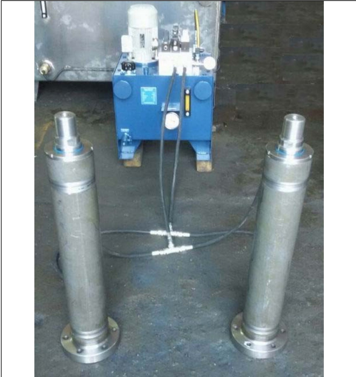
یونیت و سیلندرهای هیدرولیک مربوط به دستگاه تست بارگذاری و شکست شیرآلات انتقال گاز
