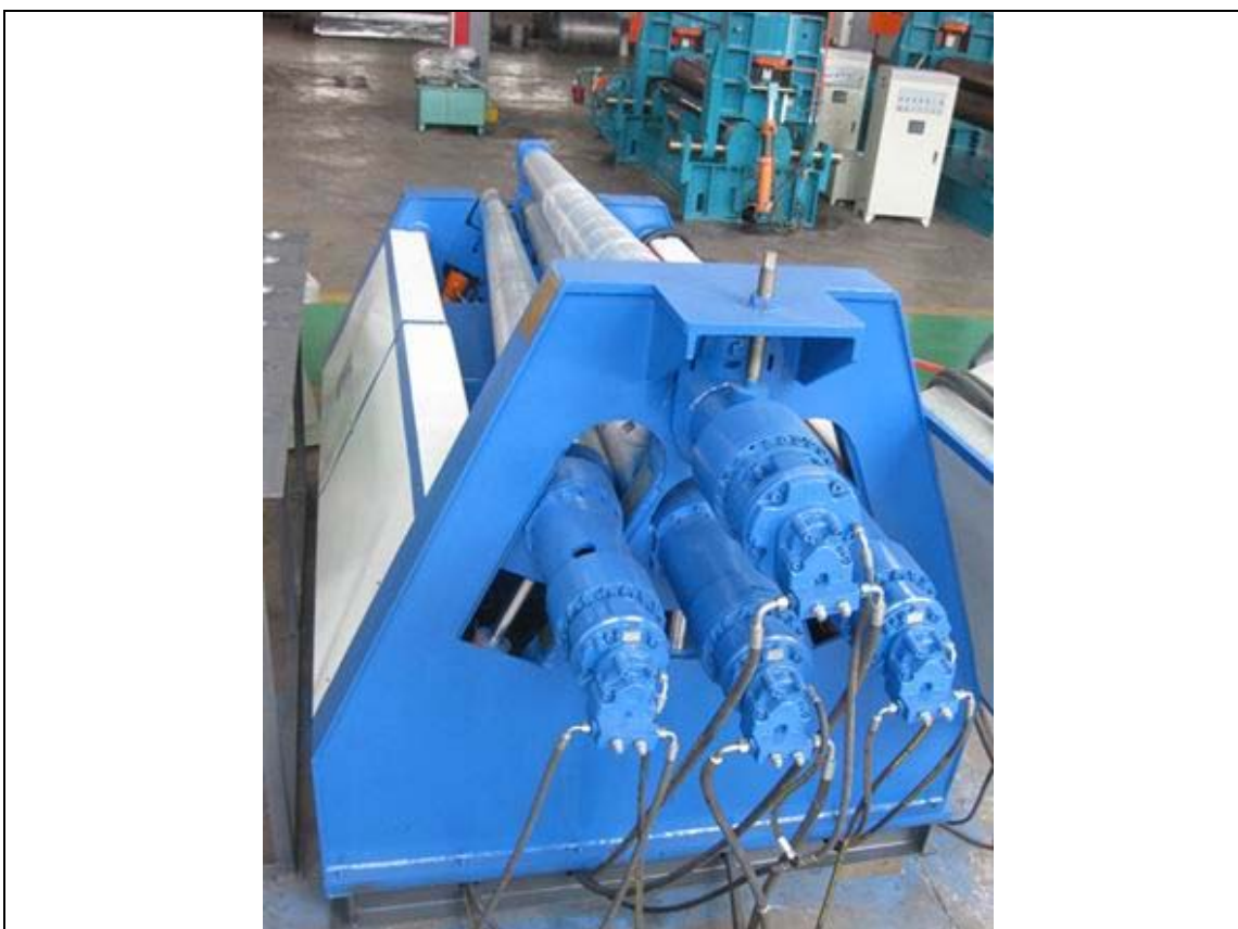
ترکیب هیدروموتور و گیربکس در دستگاه نورد
