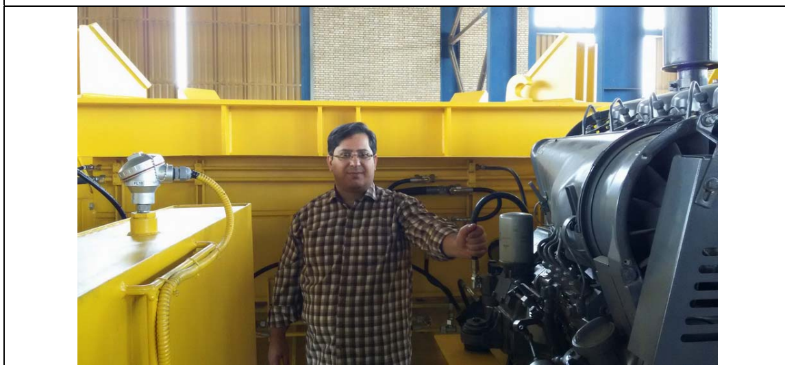
نمونه سیستم هیدرولیک در حال انجام فلاشینگ
