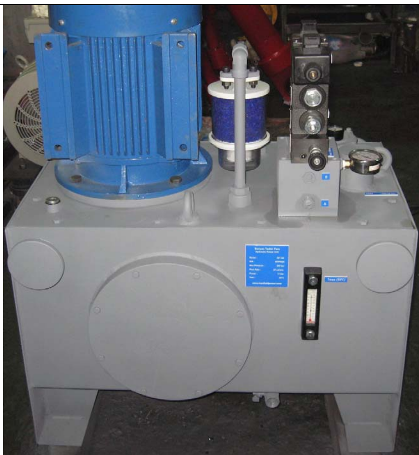
ساخت یونیت و چهار عدد سیلندر هیدرولیک جهت تقسیم دبی 28lit/min به چهار مقدار مساوی
