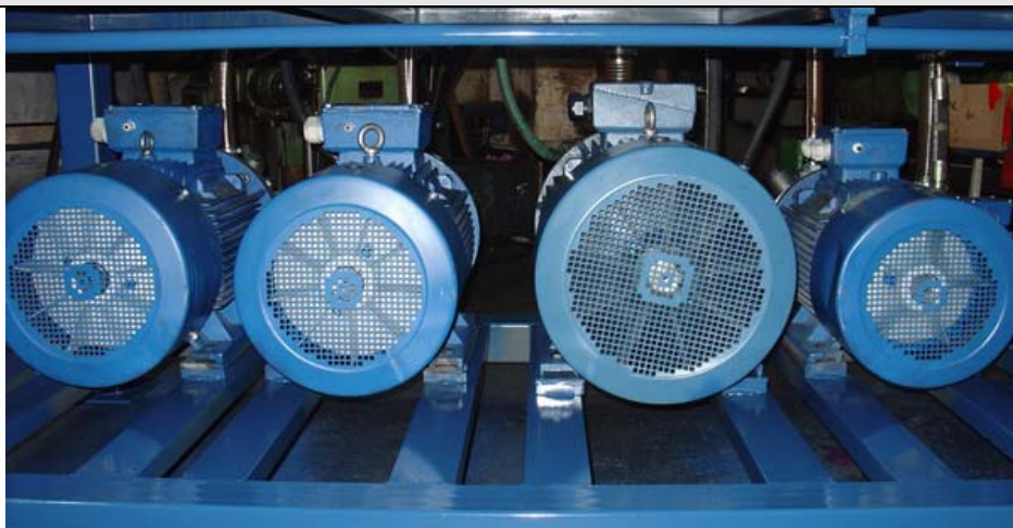
الکتروموتور (مجموع توان : 125Kw)
