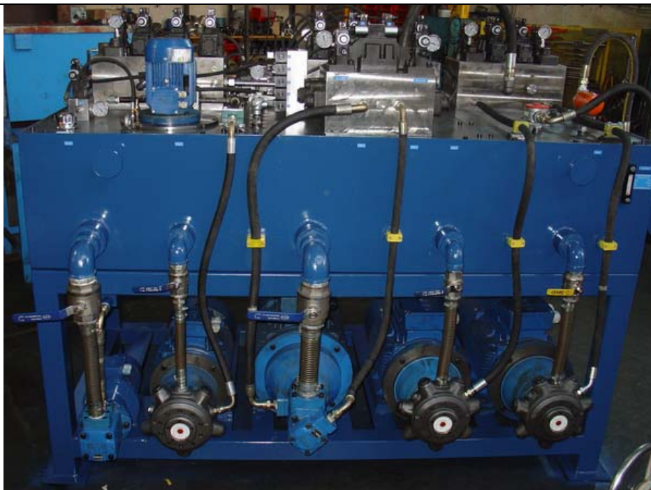
پمپهای پیستونی، تیغه ای و دنده ای - فشار ماکزیمم کاری 250bar
