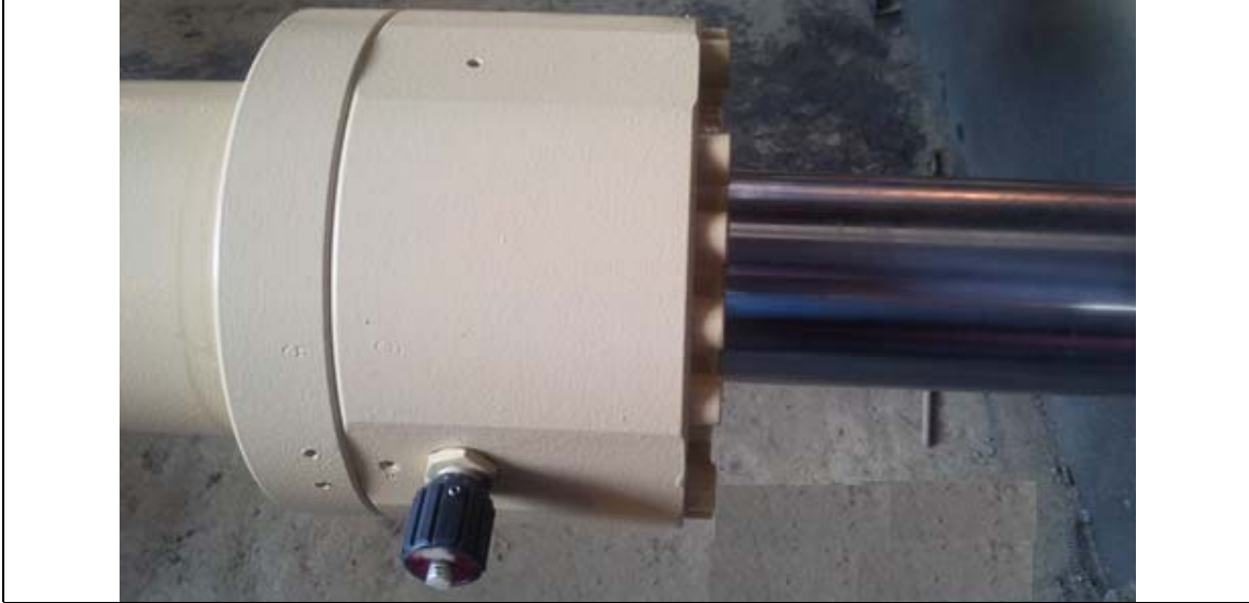
سیلندر هیدرولیک با ضربه گیر سر و ته کورس
