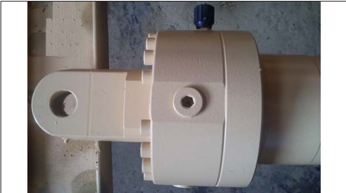
سیلندر هیدرولیک با ضربه گیر سر و ته کورس
