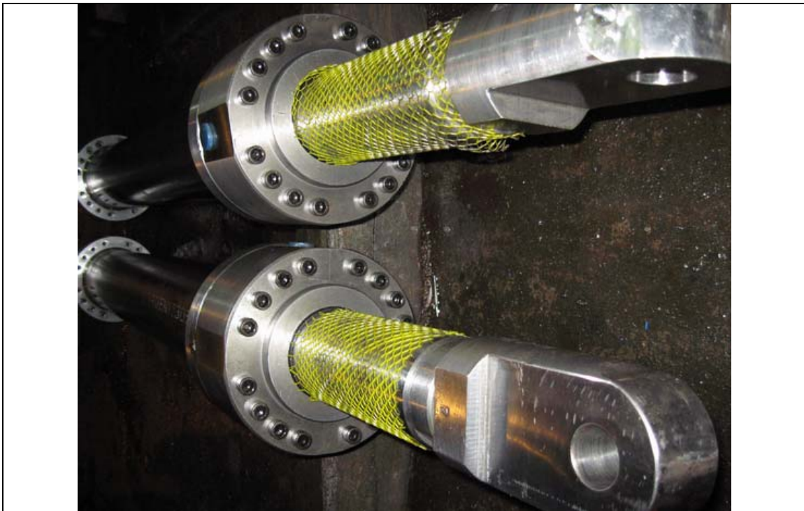
دو مجموعه سیلندر با کاشن سر و ته کورس
