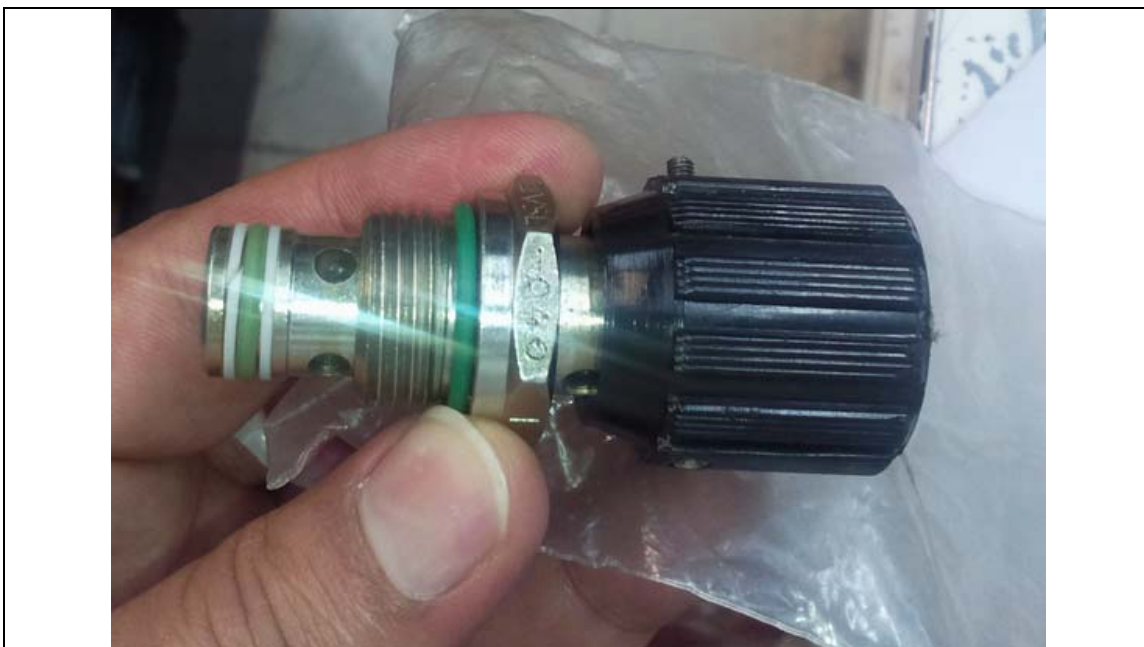
استفاده از شیر کنترل دبی کارتریج به عنوان کاشن سر و ته کورس
