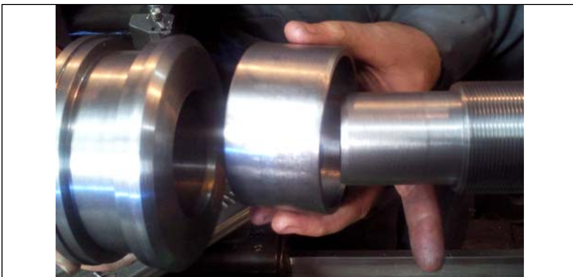
ساخت سیلندر شامل کاشن سر و ته کورس
