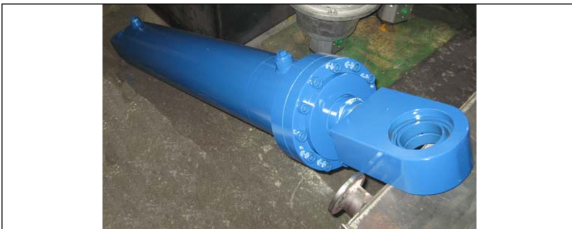
سیلندر 180/100/900 به سفارش شرکت کیمیا چوب شامل پکینگهای simrit آلمان (تیر ماه ۱۳۹۳)
