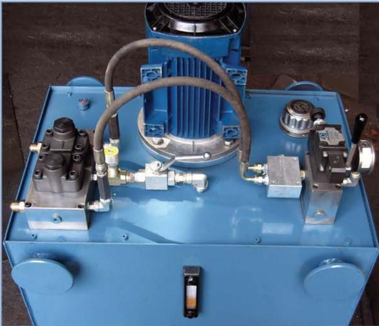
طراحی و ساخت یونیت هیدرولیک سیستم بالابر جهت حرکت سنکرون دو عدد سیلندر هیدرولیک تلسکوپی شامل فلو دیوایدر، پمپ دنده ای، شیر کنترل جهت دستی، شیر یکطرفه و فلو کنترل
