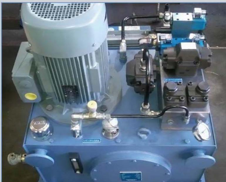
طراحی و ساخت یونیت هیدرولیک دستگاه بالابر 60ton شامل الکتروموتور 15KW، فشار شکن مدولار و شیر کنترل جهت ویکرز، شیر کانتربالانس یوکن، چک ولو پیلوتی بلوکی آتوس، خنک کن ایتالیایی، فیلتر فشار، هیتر ترموکوپل و لول سوئیچ
