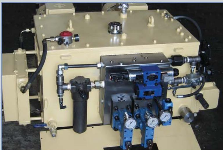
طراحی و ساخت سه مجموعه سیستم هیدرولیک دستگاه بالابر مخصوص شامل دو عدد سیلندر هیدرولیک با قطر پیستون 125mm و طول کورس 1m و کاشن در سر و ته کورس به همراه یونیت هیدرولیک شامل شیر کنترل جهت پروپورشنال رگسروت با فیدبک موقعیت از اسپول، پمپهای واریابل ویکرز و کاوازاکی به همراه شیر آلات کنترل فشار و دبی، خنک کن هوایی، هیتر، ترانزمیتر فشار، پمپ دوپل دنده ای روکت، فیلتر خط فشار و برگشت، پمپ دستی، ترموکوپل شیرهای یک طرفه پیلوتی و الکتروموتورهای افقی و آبنبد در کنار مخزن نصب شده اند
