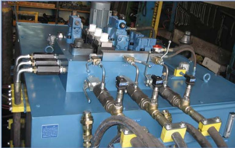
طراحی و ساخت یونیت هیدرولیک دستگاه تست اعمال فشار خستگی 260bar بر روی مخازن CNG شامل سه مجموعه پمپ هیدرولیک پارکر مجموعا با دبی 180lit/min الکتروموتورهای VEM آلمان، شیرآلات کنترل فشار و جهت از ویکرز، شیرهای کنترل دبی با مکانیزم جبران کننده فشار از دوپلماتیک ایتالیا خنک کن و ترموکوپل، پرشر ترانزمیتر، فیلتر خط برگشت به همراه تابلوی کنترل PLC از زیمنس آلمان و سیستم مونیتورینگ
