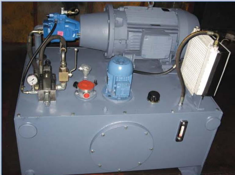
طراحی و ساخت پاورپک هیدرولیک مربوط به خطوط انتقال و پرس مواد چینی شامل پمپ واریابل مجهز به سیستم جبران کننده فشار و Load Sensing از ویکرز، مخزن ۵۰۰ لیتری، خنک کن هوایی، فیلتر کنارگذر فشار شکن و ادوات جانبی با فشار 250bar
