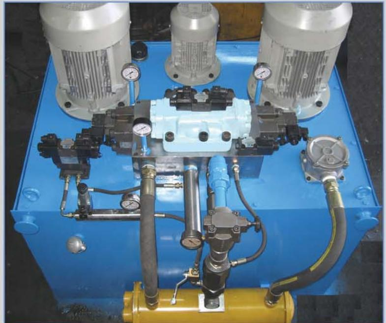
طراحی و ساخت دو مجموعه سیلندر هیدرولیک به قطر 340mm و کورس 1000mm و یونیت هیدرولیک مربوطه جهت شکل دهی گرم اتصالات بزرگ خطوط انتقال گاز شامل الکتروموتور 55Kw، شیر کنترل دبی سه راهه جهت تامین حرکت سنکرون سیلندرها، شیر کنترل جهت و فشار از آتوس و دوپلماتیک و پمپ پیستونی رکسروت با فشار کاری 210bar
