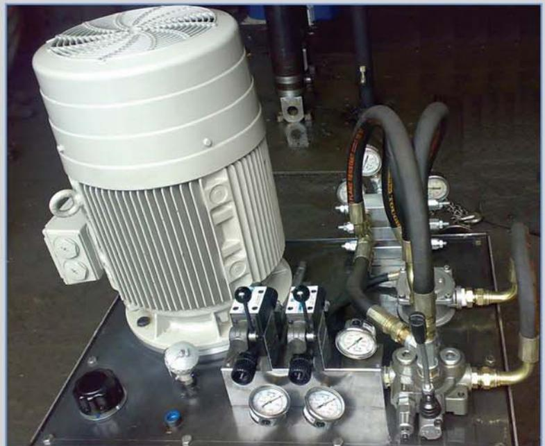
طراحی و ساخت پاورپک هیدرولیک مربوط به بالابر و وینچ هیدرولیک کشتی شامل پمپ دنده ای سه تائی کوبله شده، شیرآلات دستی، الکتروموتور 60HZ، هیدروموتور بیستونی رادیال 500cc، شیرهای کانتربالانس مربوط به سیلندره‌های بالابر (125/90/1000)
