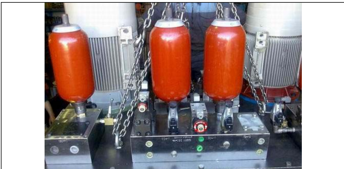
یونیت هیدرولیک مربوط به خط شکل دهی میلگرد - فرایند شارژ و تخلیه آدیباتیک
