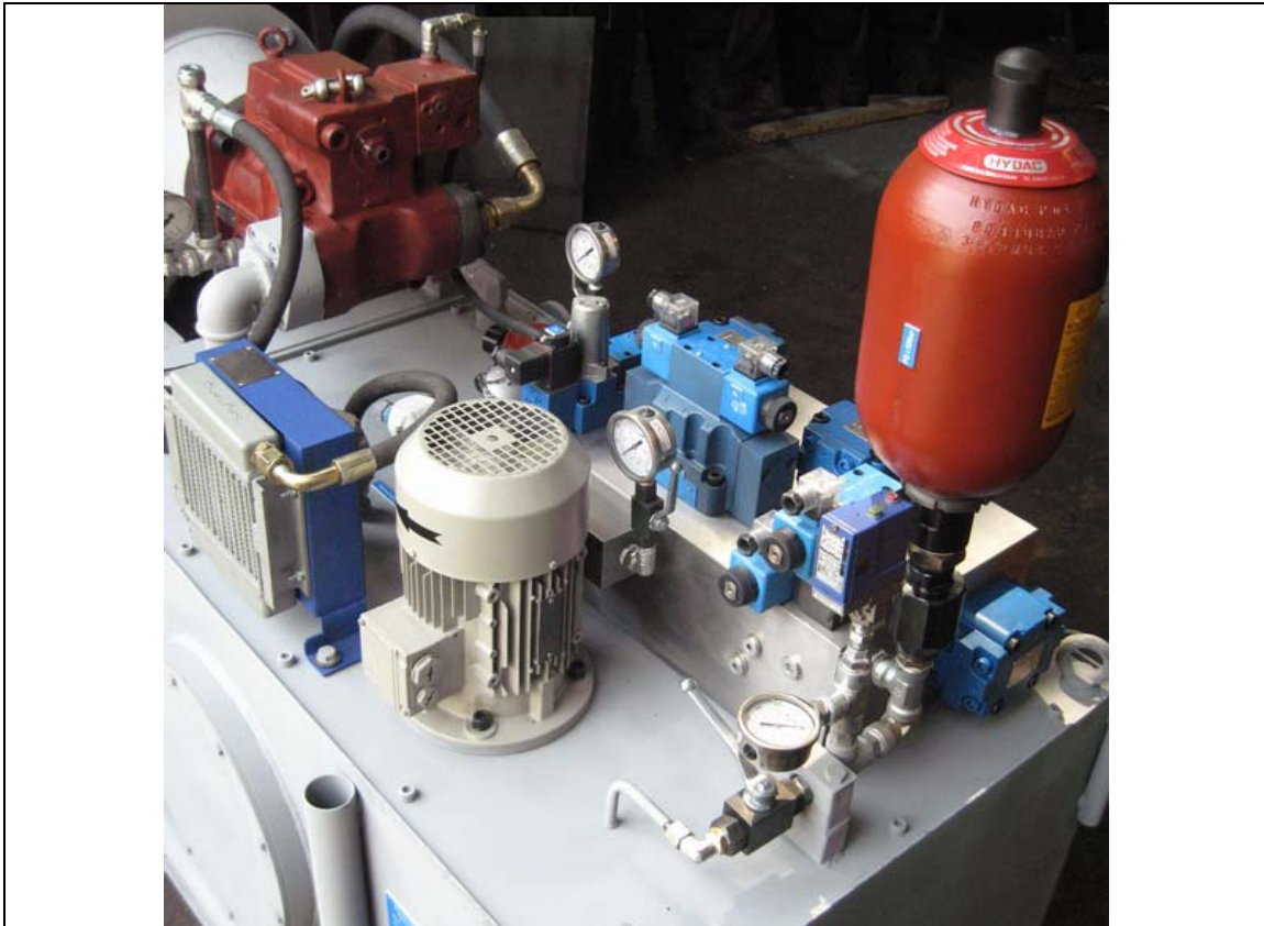
یونیت هیدرولیک مربوط به خط تولید سیمان - فرایند شارژ آدیباتیک و تخلیه ایزوترمال
