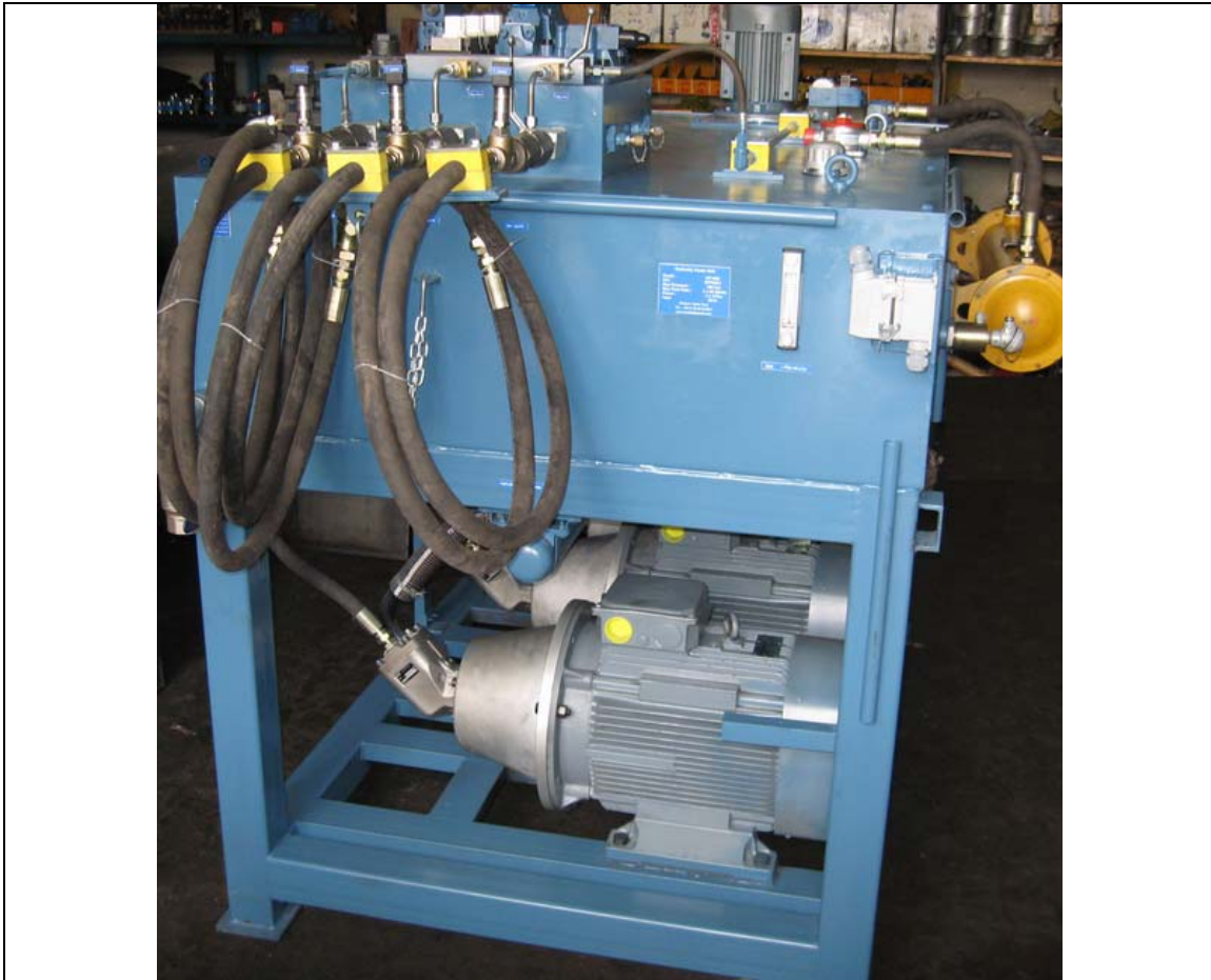
یونیت هیدرولیک دستگاه تست مخزن CNG - مخزن ۱۱۰۰ لیتری
