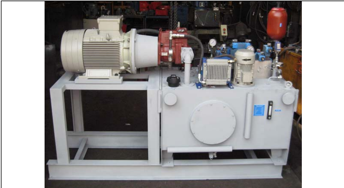
یونیت هیدرولیک ریکلایمر خط تولید سیمان - مخزن ۴۰۰ لیتری
