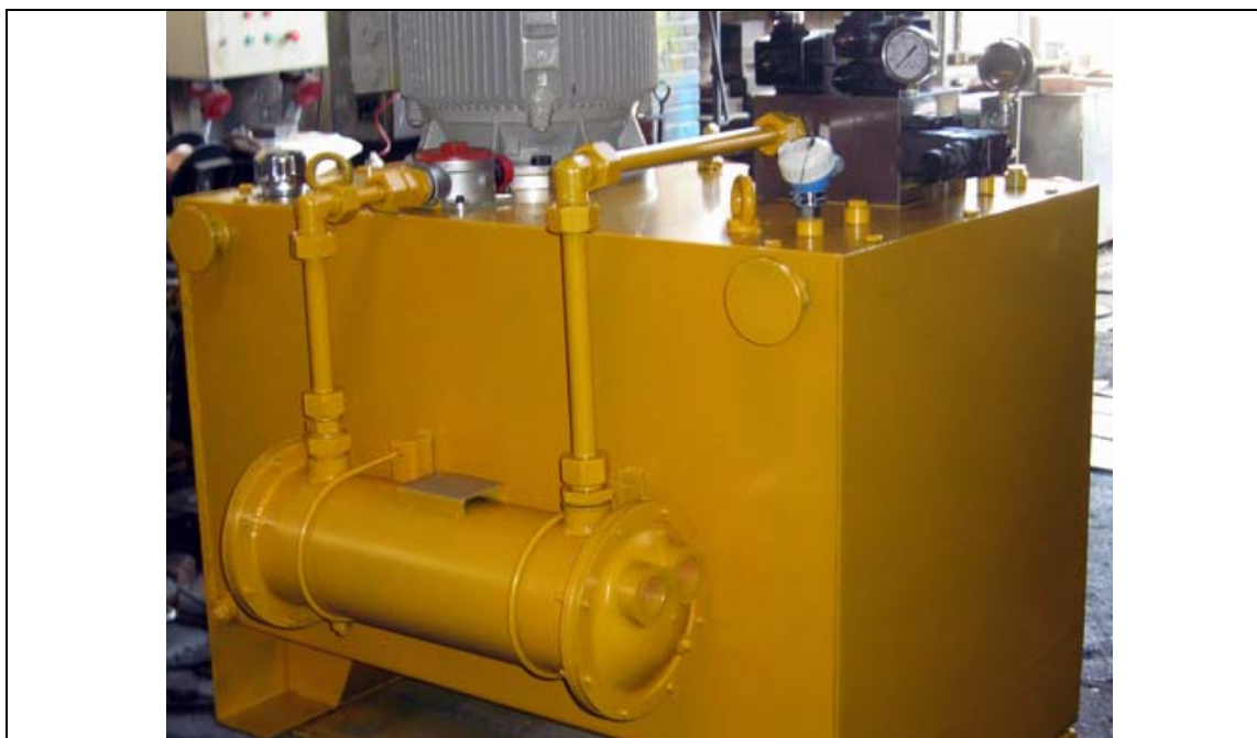
یونیت هیدرولیک فیدر سیستم رافینگ فولاد - مخزن ۴۰۰ لیتری
