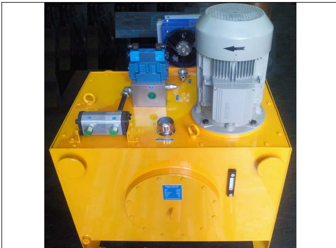
یونیت هیدرولیک خط تولید میلگرد - مخزن ۵۰۰ لیتری
