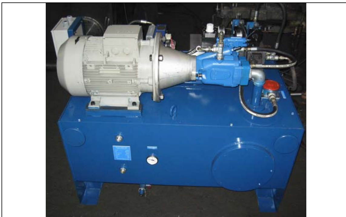
یونیت هیدرولیک کوره ذوب فولاد - مخزن ۴۰۰ لیتری
