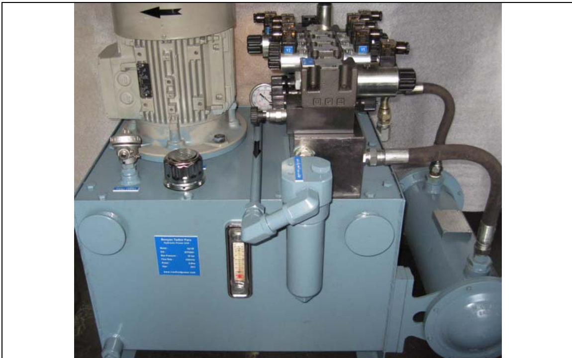
یونیت هیدرولیک کوره خلاء - مخزن ۱۲۰ لیتری
