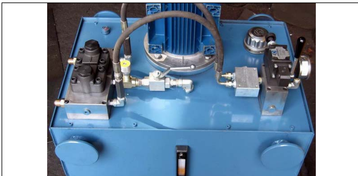
یونیت هیدرولیک دستگاه بالابر - مخزن ۲۰۰ لیتری
