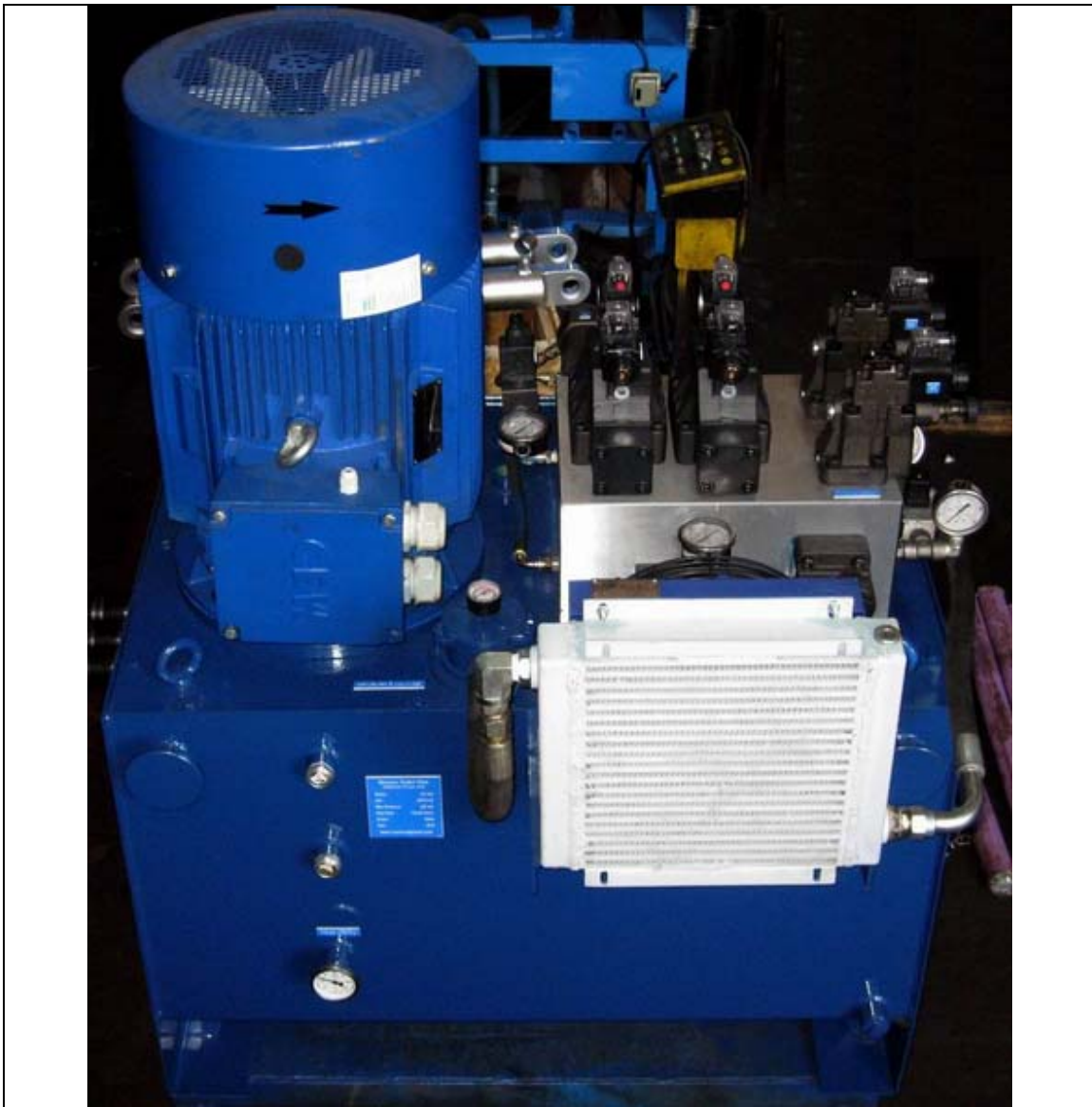
یونیت هیدرولیک پرس کامپکت مواد جانبی نیشکر - مخزن ۵۰۰ لیتری
