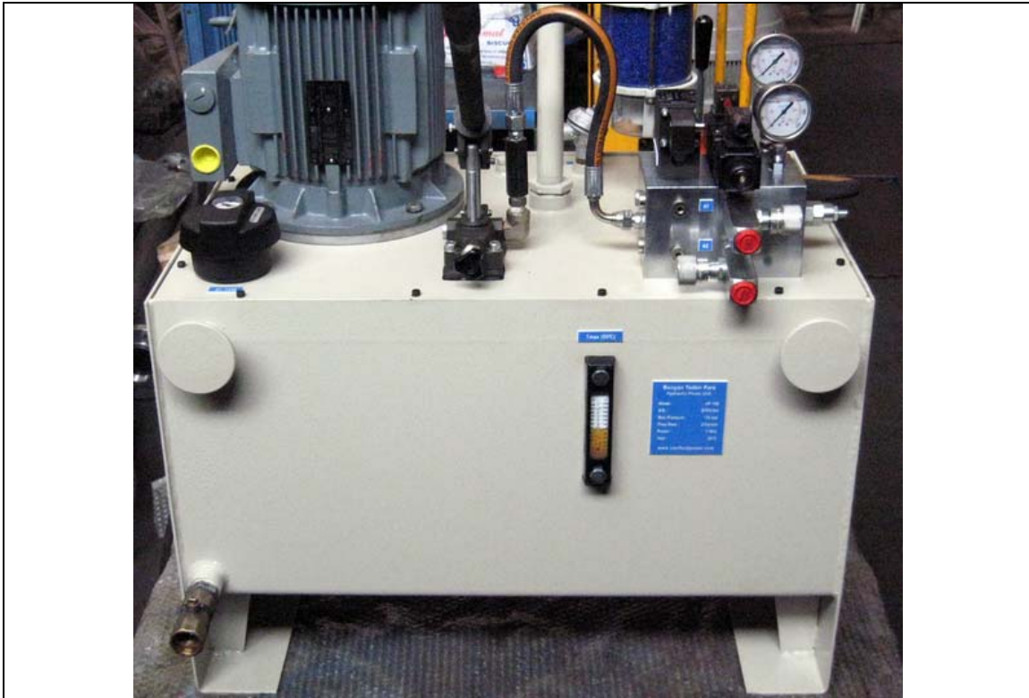
یونیت هیدرولیک باز کن دریچه آب سد - مخزن ۱۲۰ لیتری
