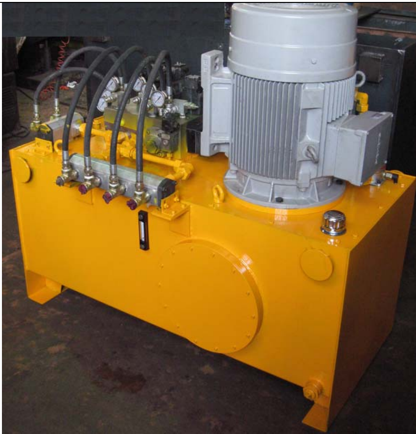
یونیت هیدرولیک فیدر سیستم برش فولاد - مخزن ۶۰۰ لیتری
