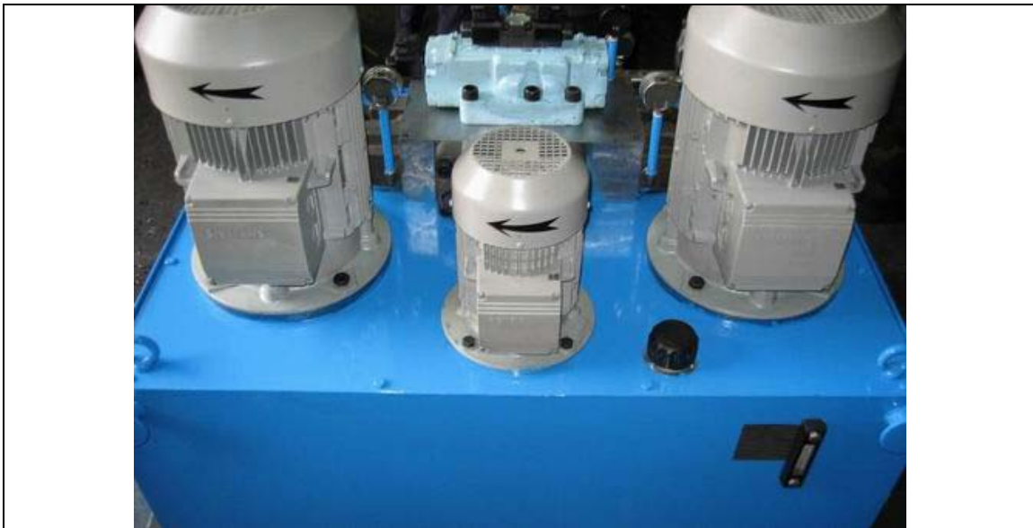
یونیت هیدرولیک پرس شکل دهی رینگ خودرو - مخزن ۶۰۰ لیتری
