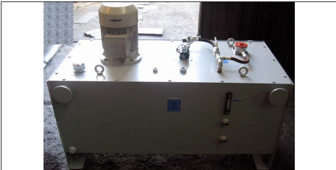
یونیت هیدرولیک بالابر سیلندر تلسکوپی - مخزن ۶۰۰ لیتری
