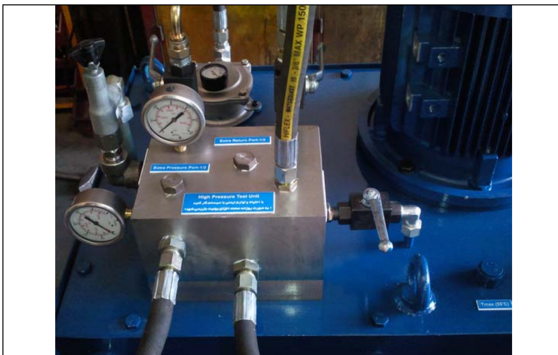
طراحی و ساخت یونیت هیدرولیک تست 500bar ، شامل پمپ پیستونی رادیال، شیر کنترل فشار HAWE آلمان، شیرهای ربع گرد Rotelmann، فیلتر خط برگشت Hydroline و ...
