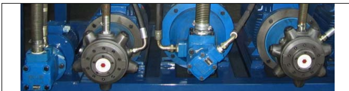
طراحی و ساخت یونیت هیدرولیک 250bar شامل پمپهای پیستونی رادیال (اسفند ۹۱)
