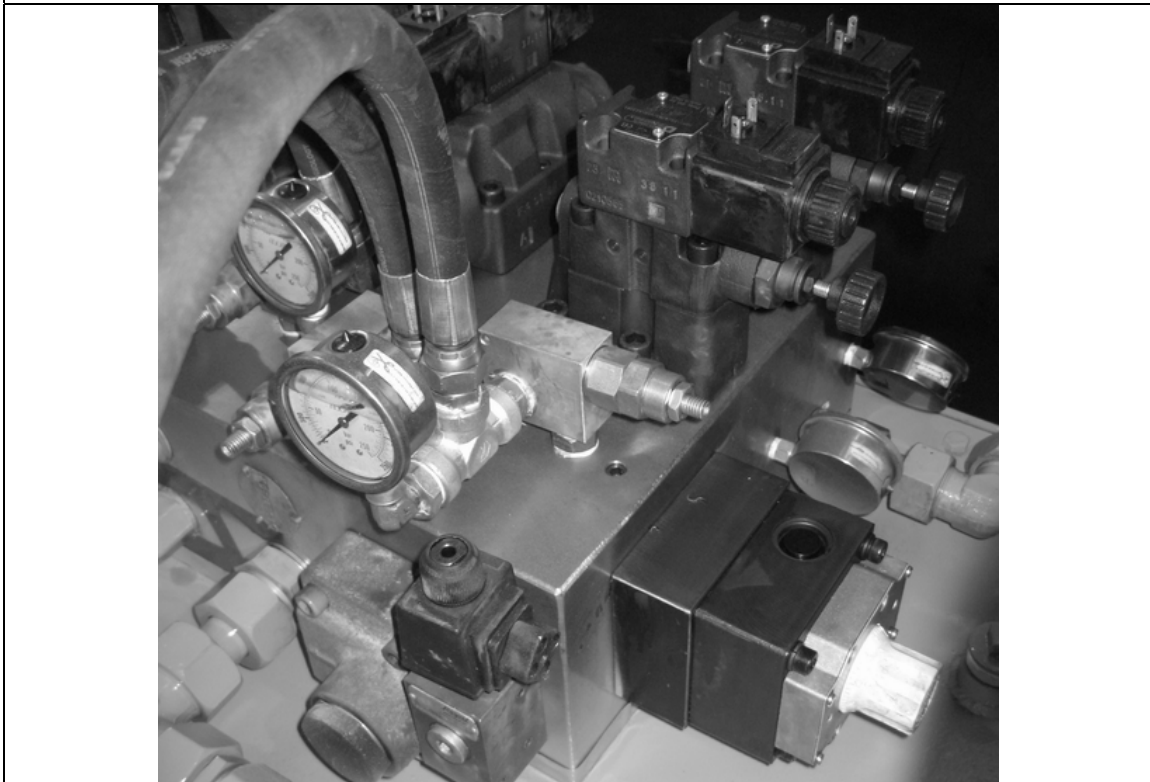
به سفارش شرکت فولاد و میلگرد سیرجان یونیت هیدرولیک مربوط به دستگاه برش بیلت فولادی - استفاده از شیر فلو کنترل به صورت Bleed off
