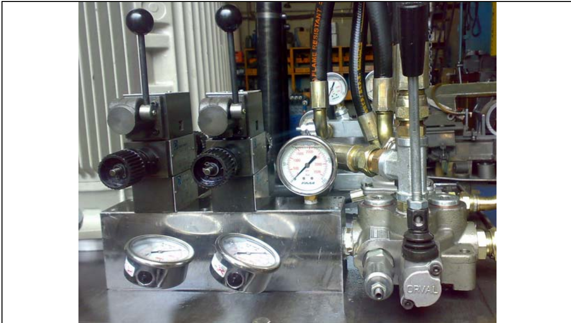
به سفارش شرکت سیوان یونیت هیدرولیک مربوط به وینچ دریائی - استفاده از شیر فلو کنترل به صورت Meter in
