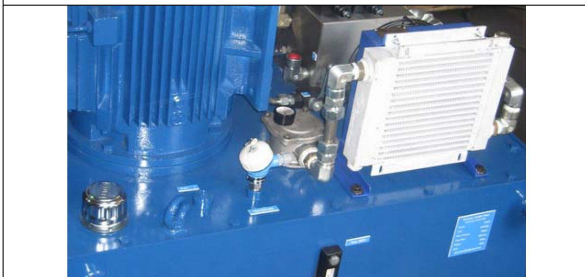
فیلتر خط برگشت - مش 25 میکرون - Hydroline هند
