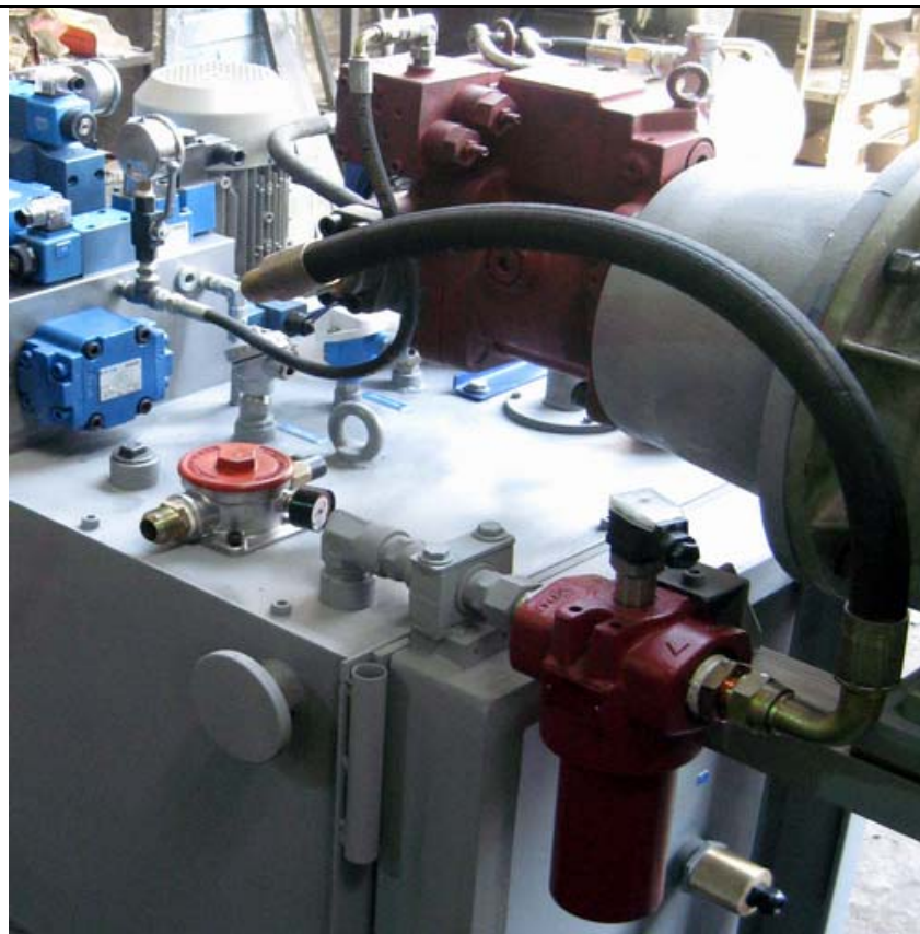
فیلتر خط فشار - مش 10 میکرون - HYDAC آلمان
