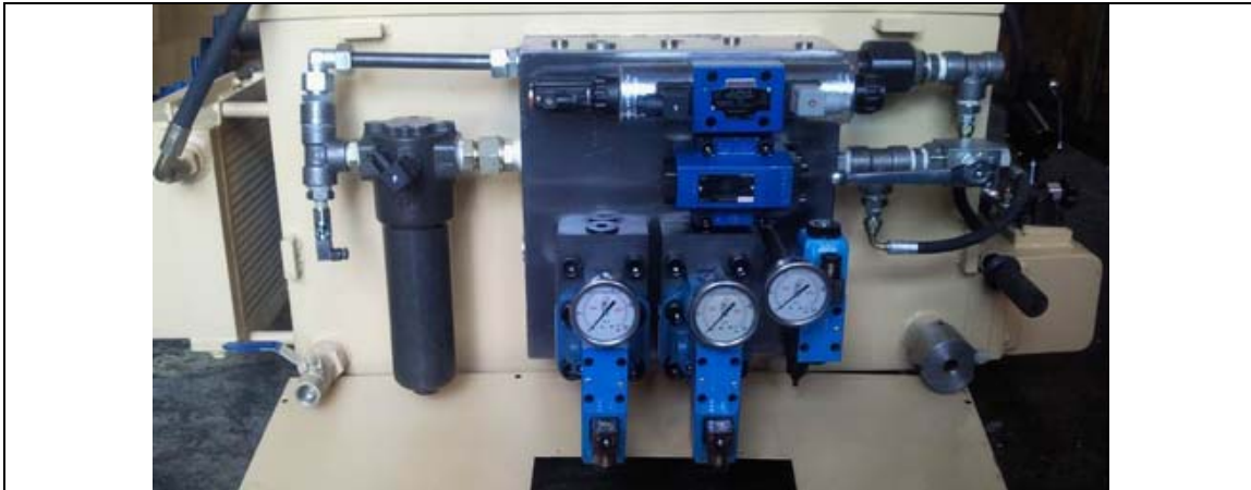
یونیت هیدرولیک شامل خنک کن هوایی مربوط به سیستم بالابر شامل پمپهای واریابل و شیر پروپورشنال
