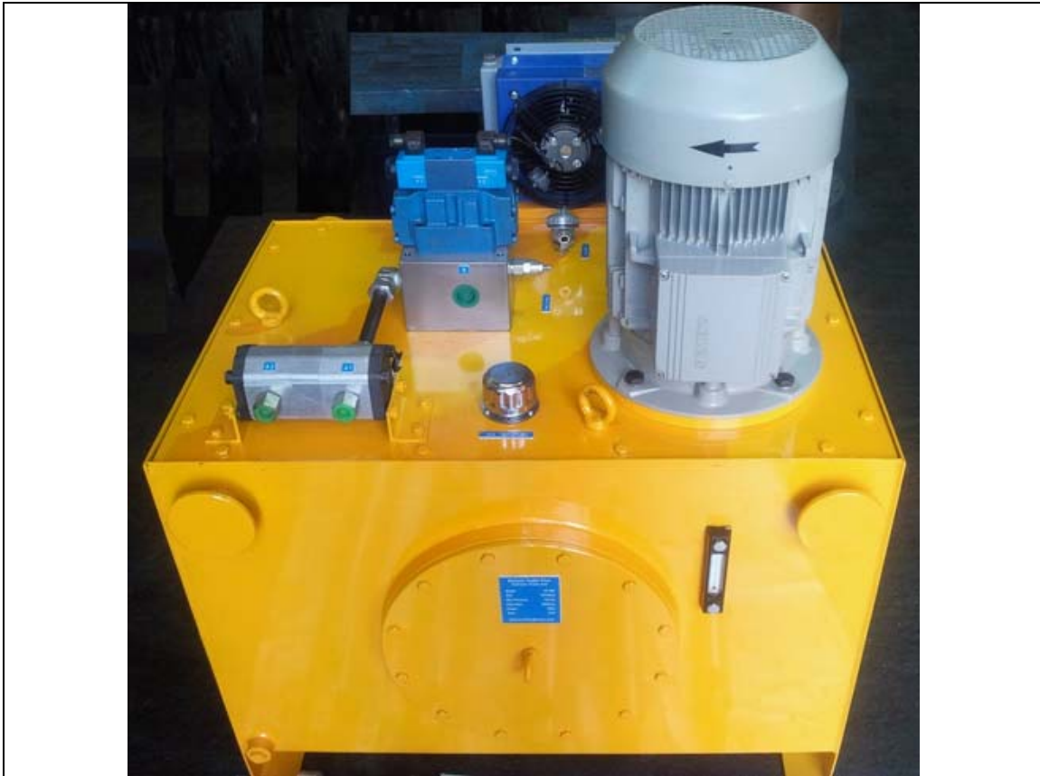
یونیت هیدرولیک شامل خنک کن هوایی به سفارش شرکت میلگرد سیرجان شامل فلو دیوایدر هیدروموتوری
