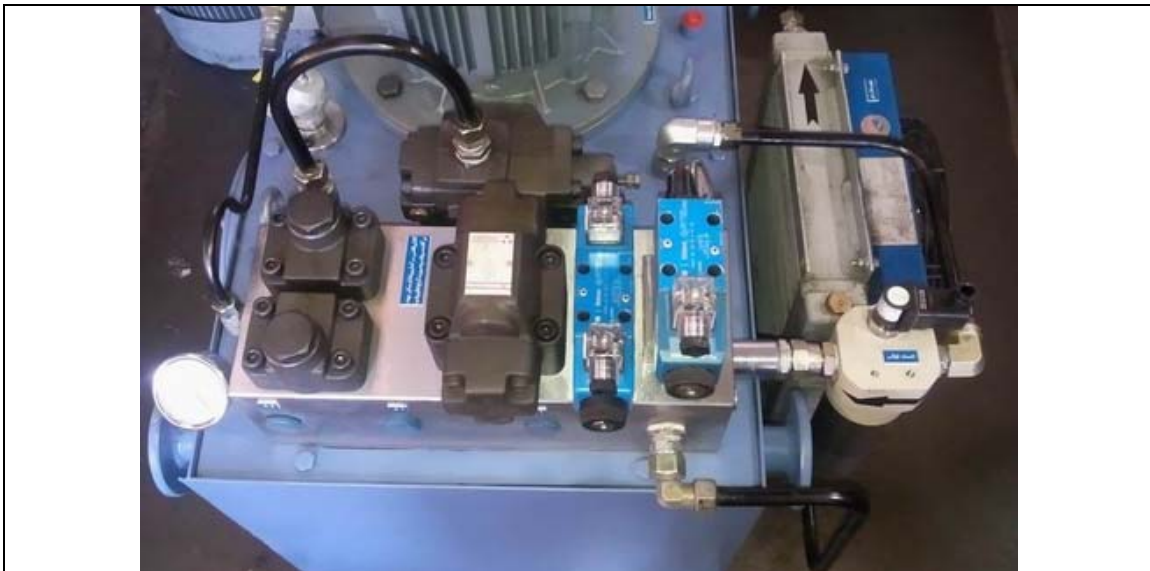
یونیت هیدرولیک شامل خنک کن هوایی به سفارش شرکت دنا قطعه اروین شامل شیر کانتر بالانس
