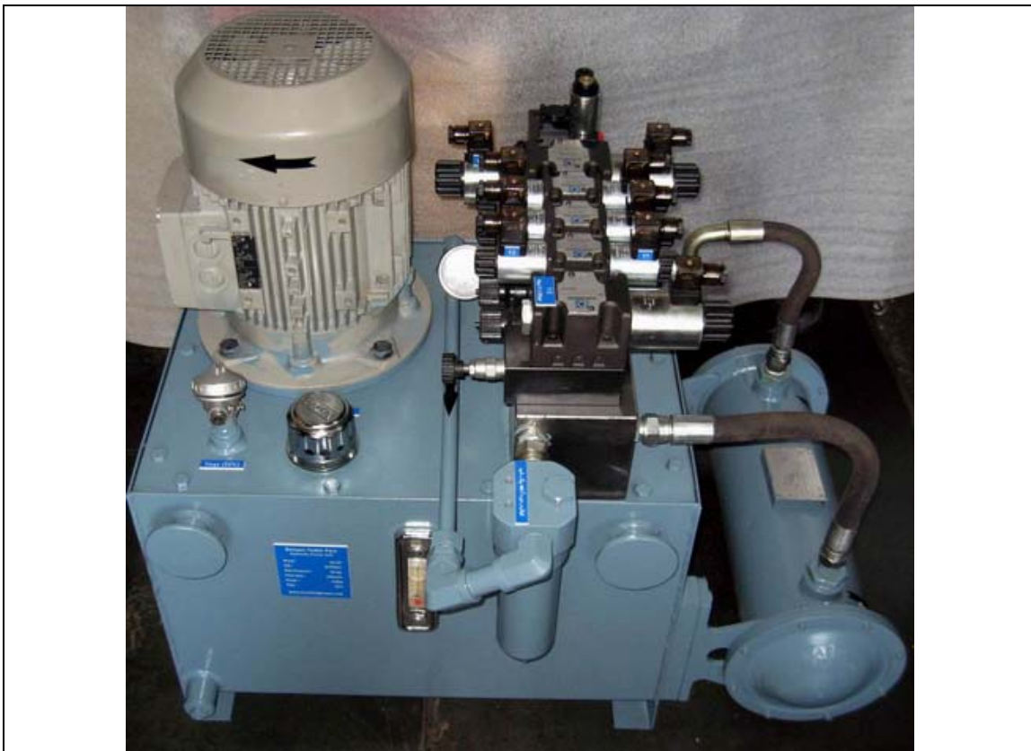
یونیت هیدرولیک شامل خنک کن آبی به سفارش شرکت مپنا شامل شیر فلو کنترل پروپورشنال
