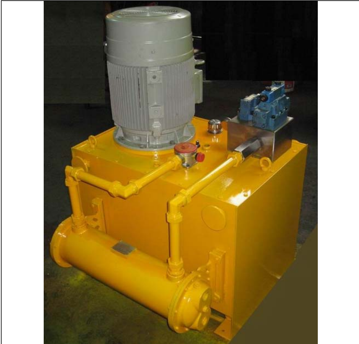
یونیت هیدرولیک شامل خنک کن آبی به سفارش شرکت میلگرد سیرجان
