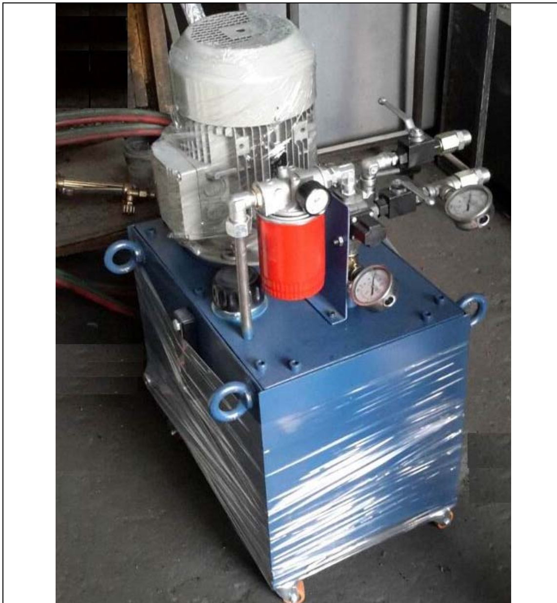
یونیت هیدرولیک تست فشار- حداکثر فشار 350bar یونیت مجهز به الکتروموتور و پمپ هیدرولیک پیستونی، شیرآلات دستی کنترل فشار و کنترل جهت، گیج فشار 400bar کالیبره شده و فیلتر خط برگشت میباشد.
