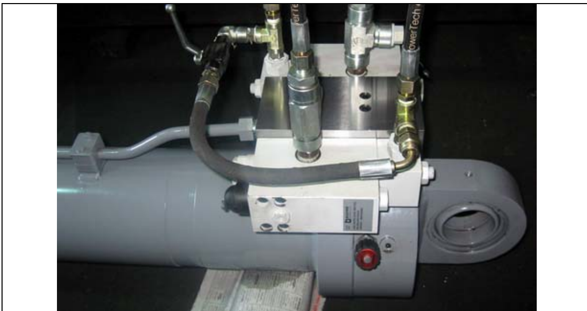
شیر کنترل بار ( Bucher ) - سیلندر هیدرولیک دستگاه استکر - سال ۹۲
