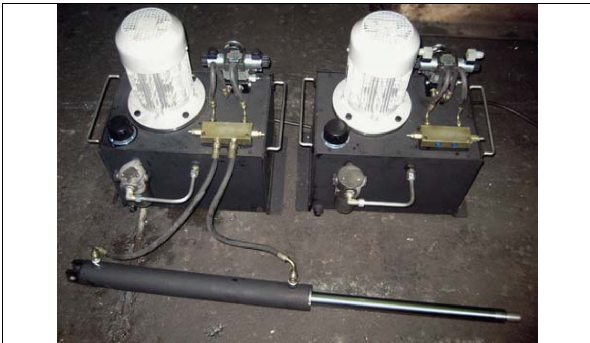
استفاده از شیر اورستتر در سیستم هیدرولیک باز و بسته نمودن دریچه - سال ۸۷
