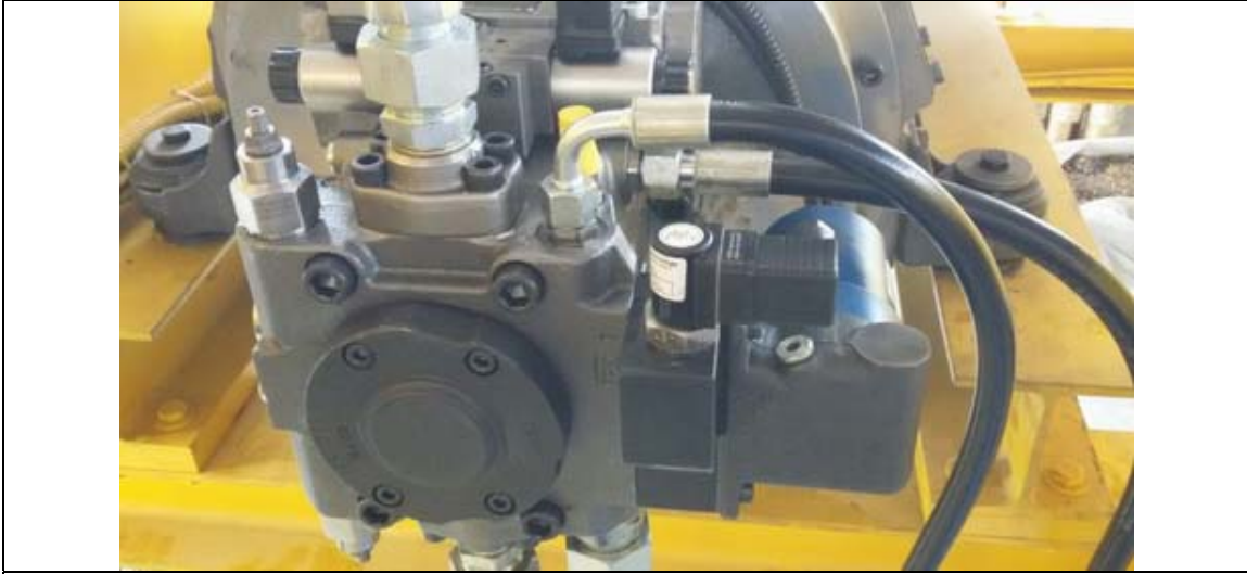
پمپ دنده ای شارژ و تامین فشار پیلوت مدار
