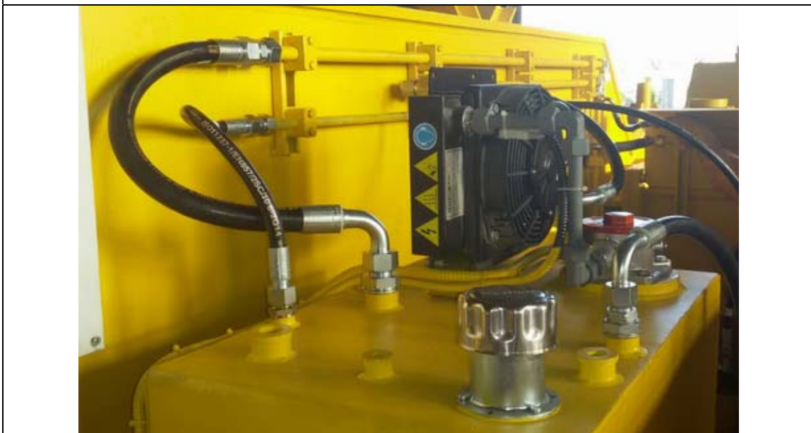
مخزن روغن پمپ شارژ به همراه کولر، فیلتر و ادوات جانبی
