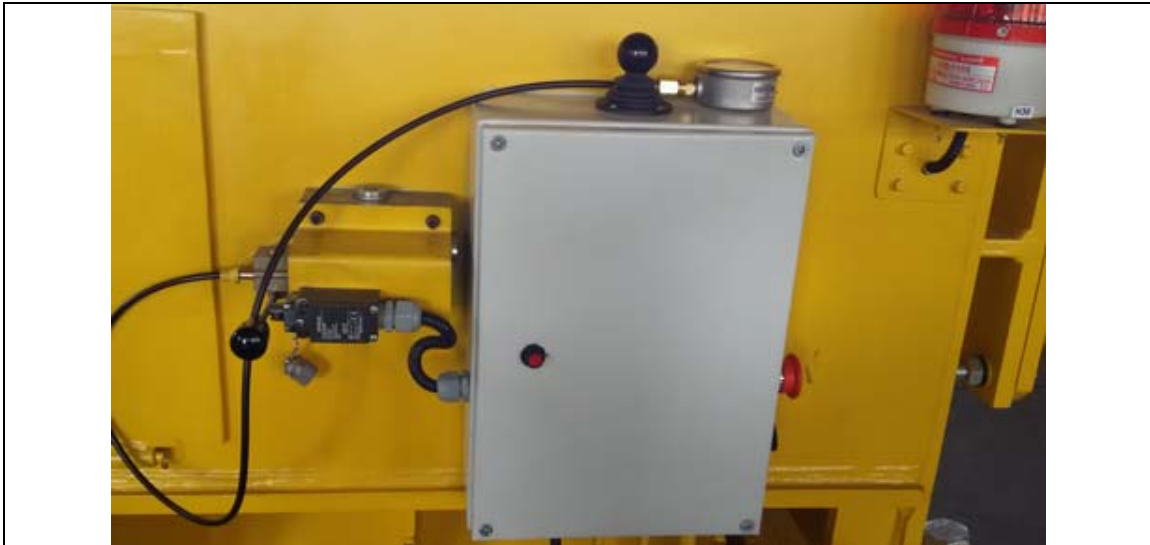
جوی استیک تحریک شیر پروپورشنال پمپ هیدروستاتیک و شیر تحریک قفل گیرکسها
