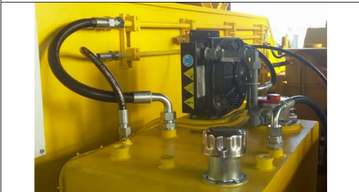
مخزن روغن پمپ شارژ به همراه کولر، فیلتر و ادوات جانبی
