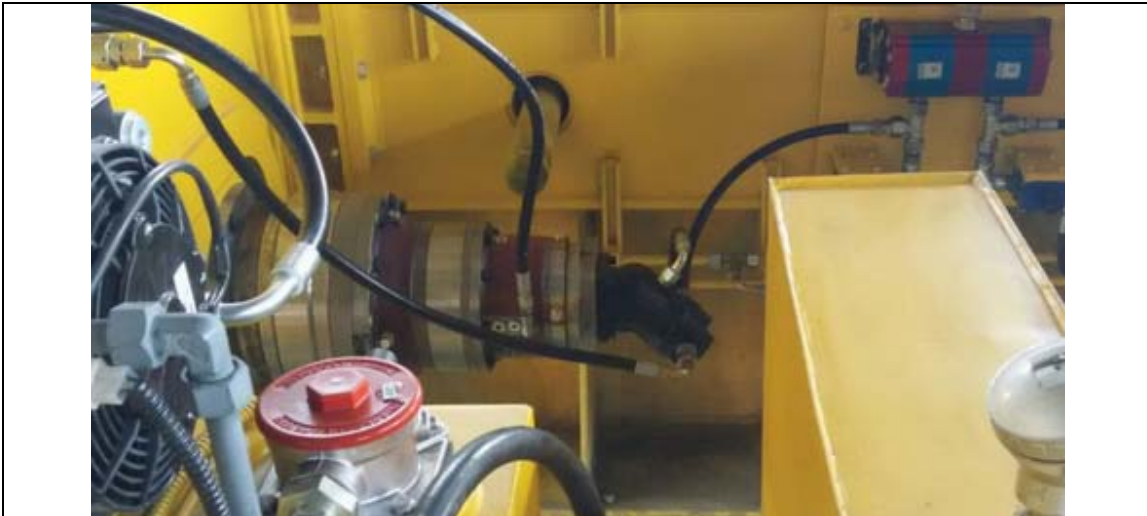
فلو دیوایدر با نسبت یک به دو برای سنکرون نمودن سرعت حرکت هیدروموتورها
