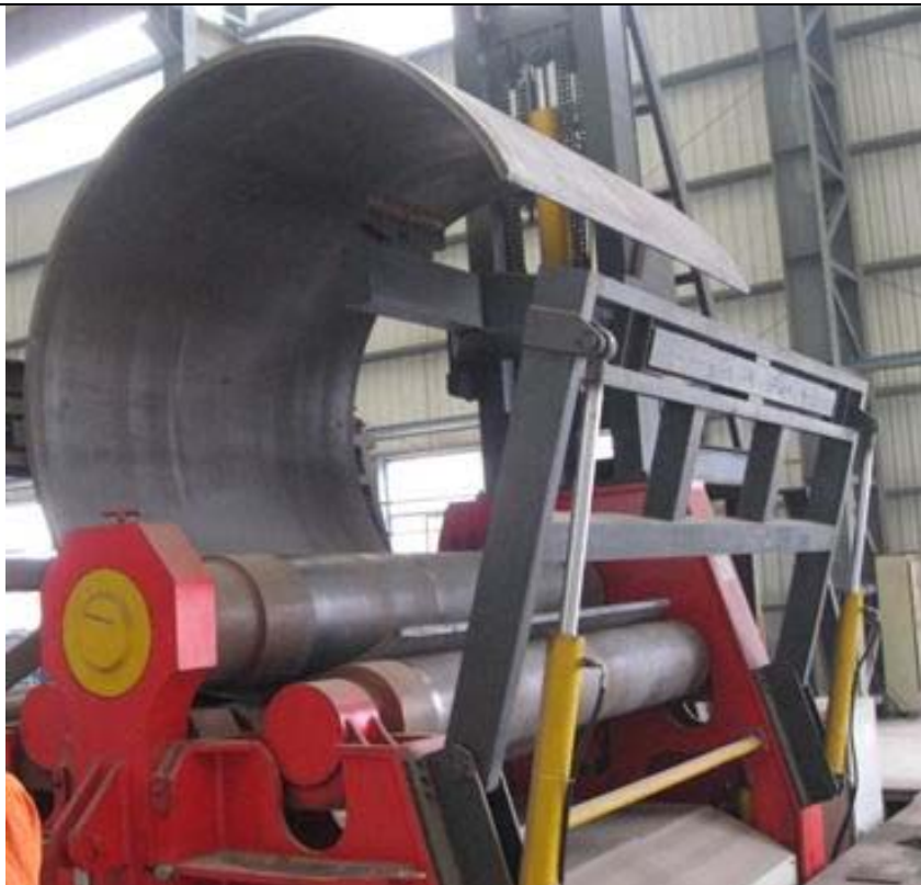
دستگاه رولینگ ورق فولادی با فشار کاری 250bar
