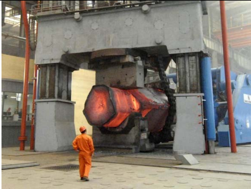
پرس هیدرولیک با فشار کاری 350bar جهت تامین نیروهای بسیار زیاد در صنعت فولاد
