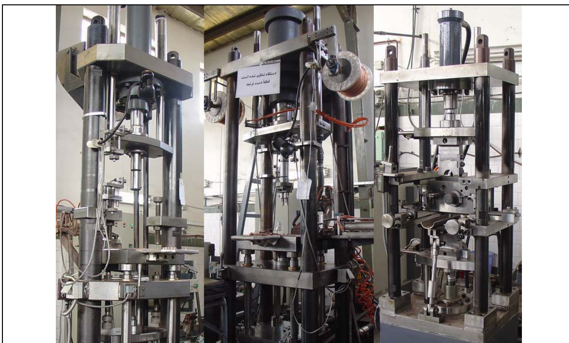
(۱) پرس ۴ تن خمکاری پوشهای بی متال (۲) پرس ۴۰ تن متالورژی پودر تولید ذغالهای استارت و دینام خودرو (۳) پرس ۲۰ تن متالورژی پودر تولید گیت سوپاپ
