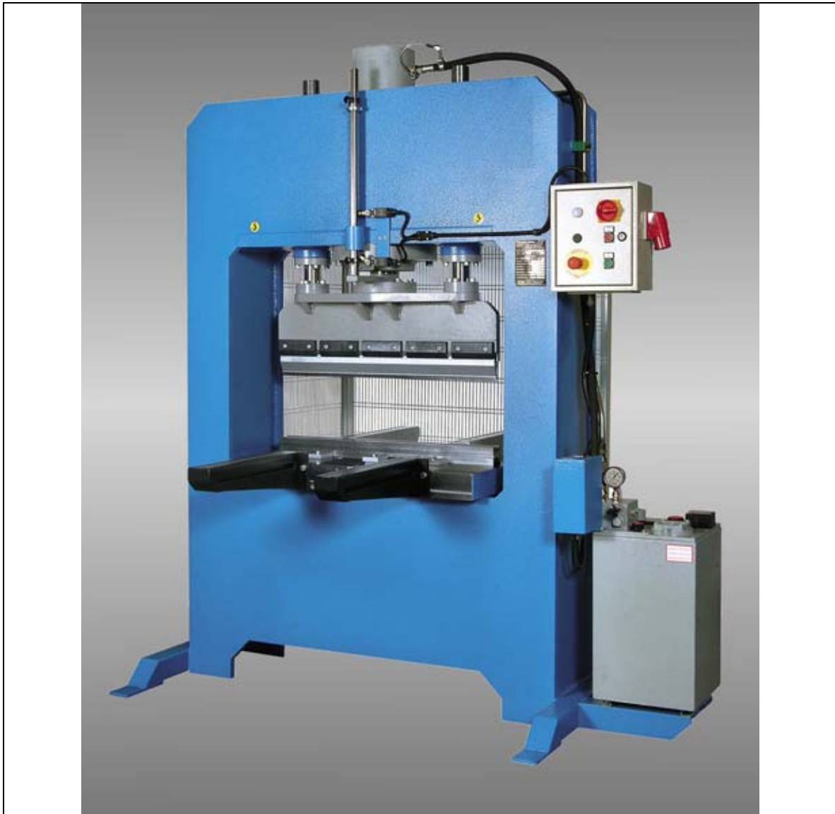
پرس هیدرلیک خمکاری ورق
