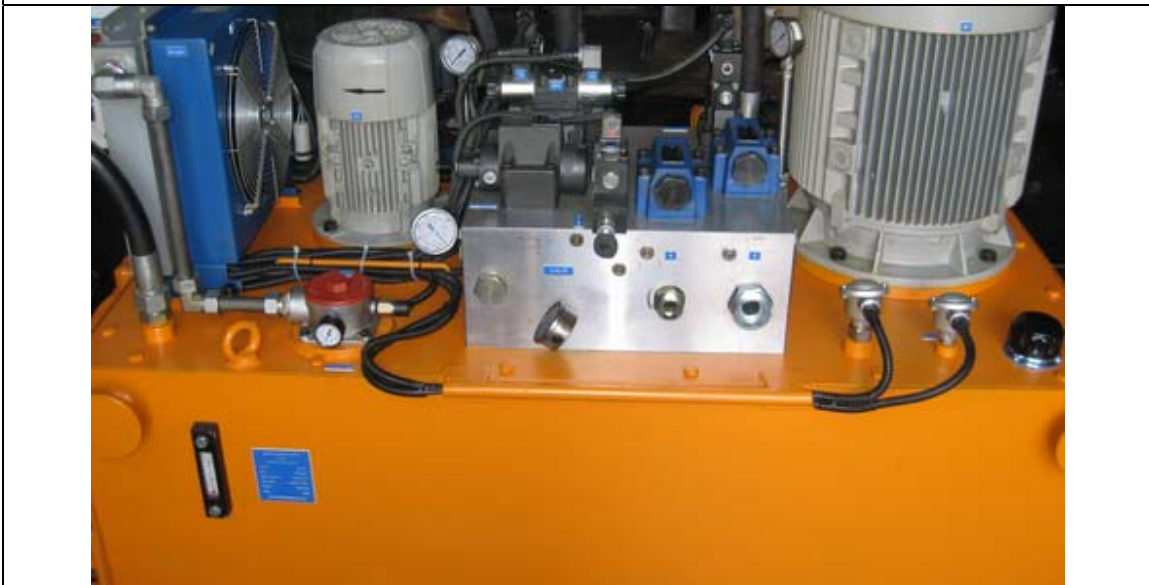
پورتهای ورود و خروج روغن خنک کن و بلوک اصلی
