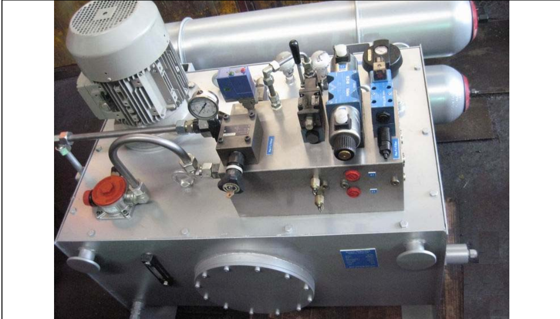
یونیت هیدرولیک شامل پمپ دنده ای Tundish drying station of continuous casting system (CCM)
