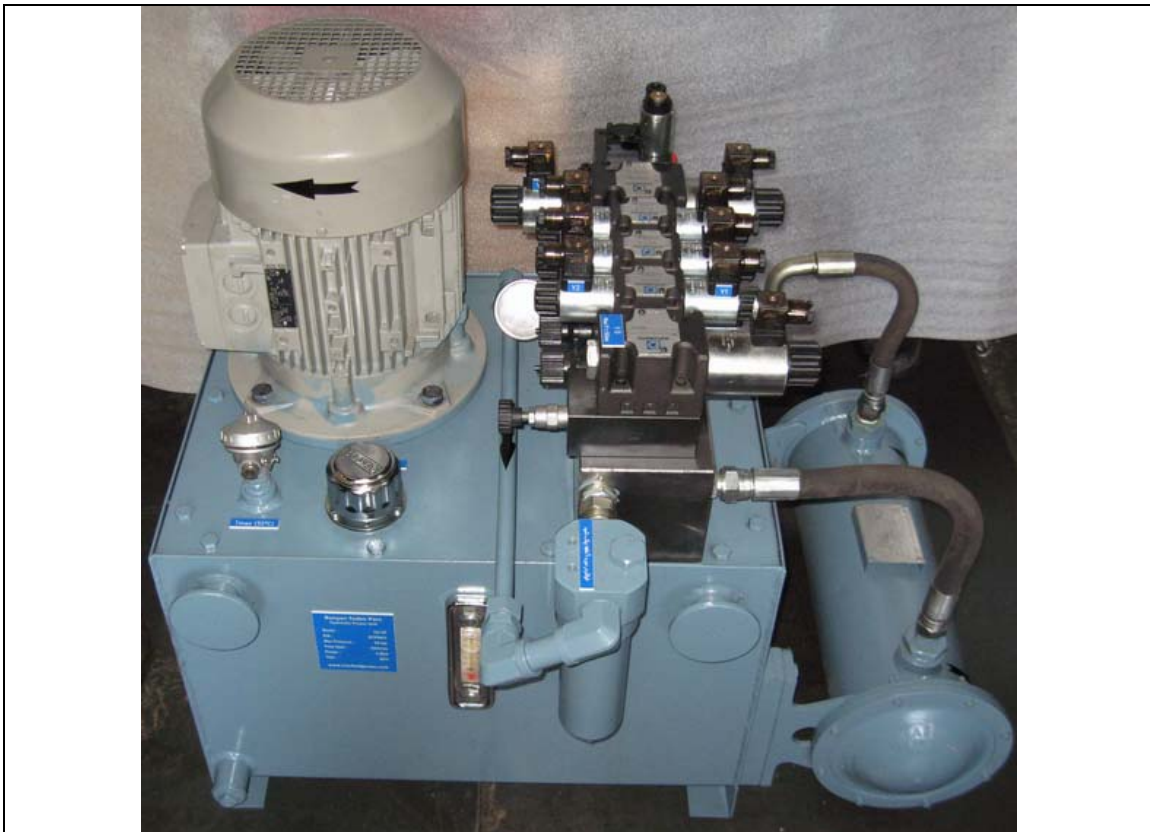
پورت نصب نشانگر انسداد فیلتر مسدود شده است
