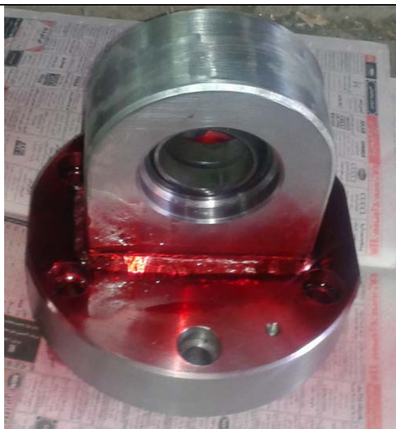
انجام تست مایعات نافذ (PT) قطعه لولایی انتهایی سیلندر- ۱۳۹۳
