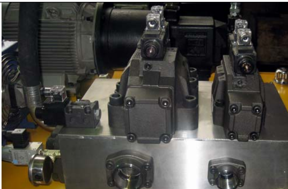
یونیت هیدرولیک دستگاه پرس 100 تن شامل Decompression روغن سیلندر به قطر 270mm و کورس 3m با فشار کاری 180bar - سال ۹۲
