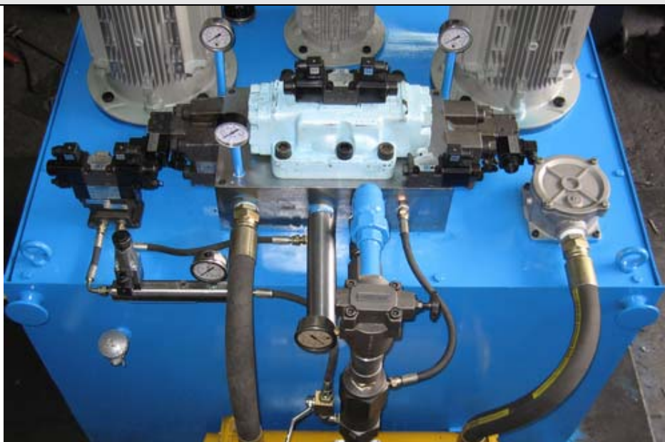
یونیت هیدرولیک دستگاه پرس 180 تن شامل Decompression روغن سیلندر به قطر 400mm و کورس 900mm با فشار کاری 150bar - سال ۸۷
