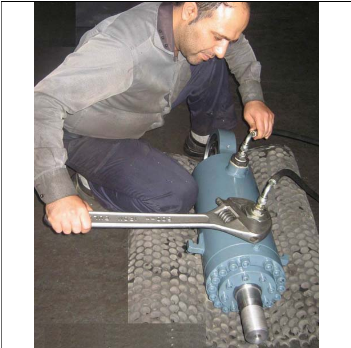
تست فشار سیلندر و بررسی نشتی
