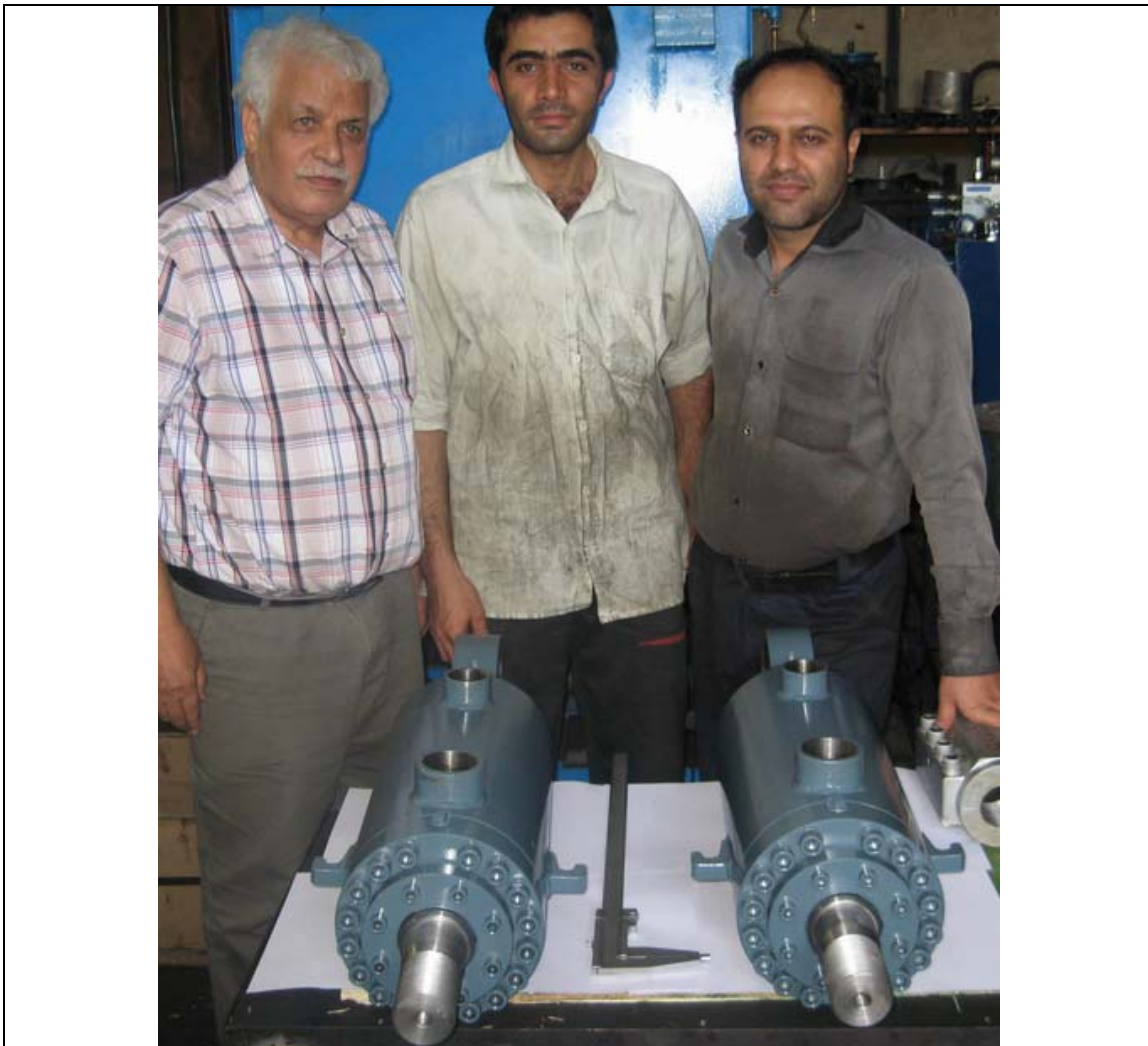
ساخت سیلندرهای تجهیز Roller Miller صنعت فولاد - سایز 160/75/110
